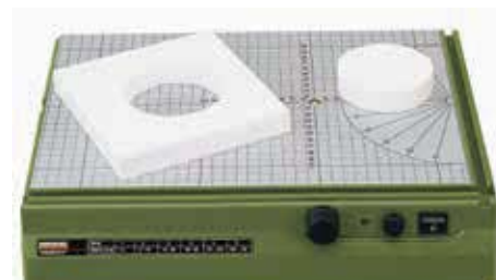
Pro řezání oblých tvarů je jednoduché řešení: připevníte (např. izolepou) napínaček ke stolu. Slouží jako otočný bod.
